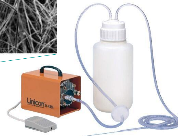
廃液吸引ユニット
